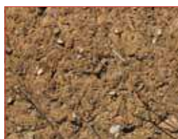
Couleur et texture de la bauge.
