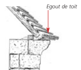
Les égouts de toiture présentent une rupture de pente ici créée par la superposition de tuiles sur la corniche.
