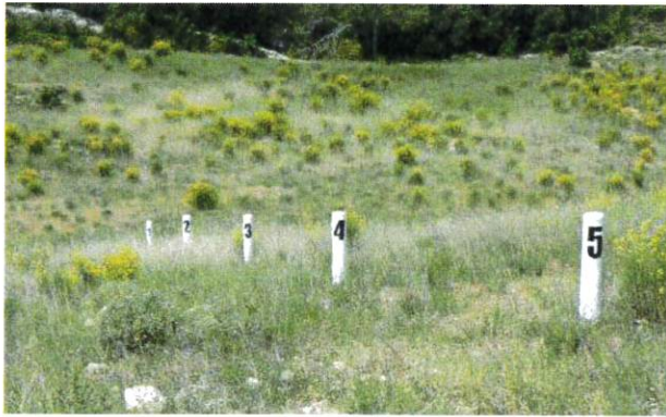
Figure 7: bornes limnimétriques (source : Ingetec)
