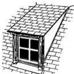
lucarne rampante ou en chien couché
