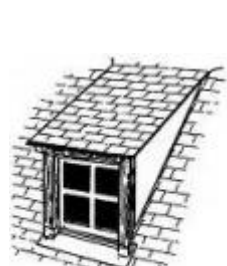
lucarne rampante ou en chien couché
