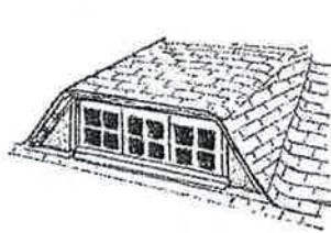
lucarne en trapèze (couverture en bardeaux d'asphalte)
