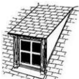
lucarne rampante ou en chien couché
