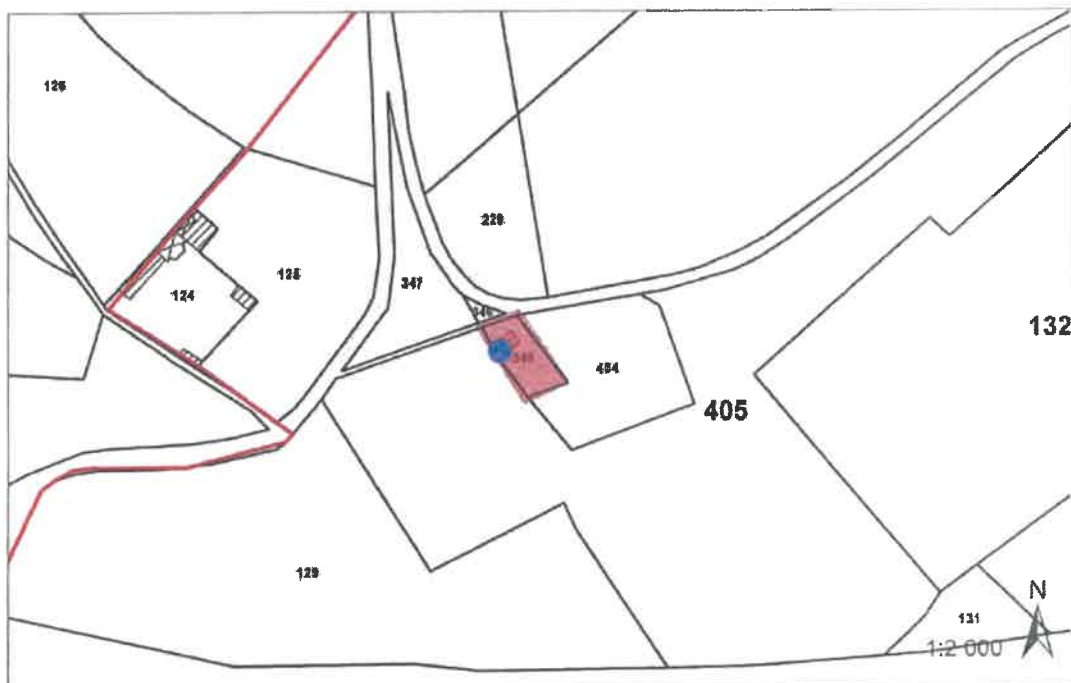
Périmètre de protection Immédiate du forage de La Croisille 1 (01497X0029)
