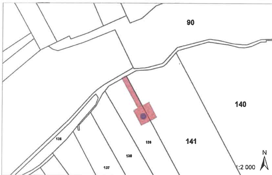
Périmètre de protection immédiate du forage de La Croisille 2 (01497X0037)
