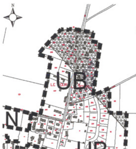
Figure 22bis : Secteur de risques technologiques, dans la zone UB de la Route d'Aizier, résultant de la proximité du tracé du pipeline Le Havre-Paris de 813 mm
