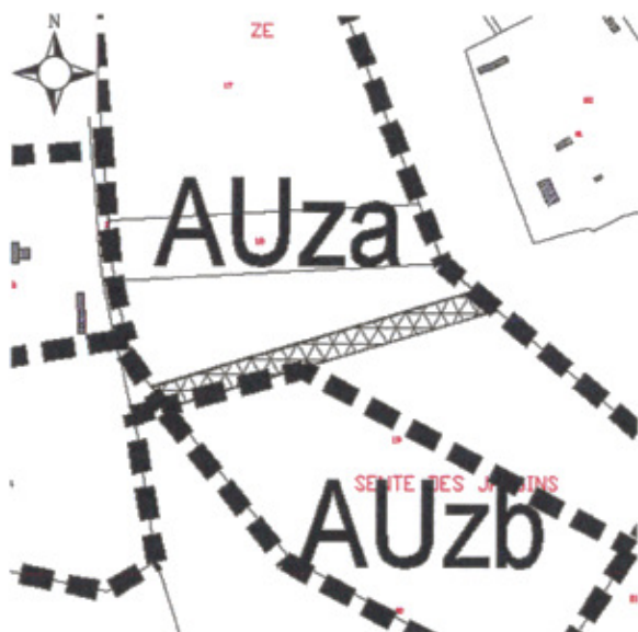
Figure 22 : Secteur de risques technologiques, dans la future zone d'activités, de part et d'autre de la canalisation de transport de gaz de Bourneville à Manneville-sur-Risle
