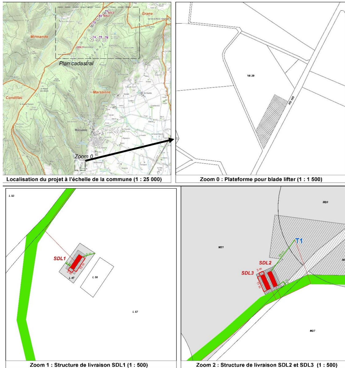
Figure 23 : zoom du plan cadastral sur les structures de livraison (SDL) intrasite et sur la plateforme de chargement-déchargement pour le blade lifter (extra-site)
