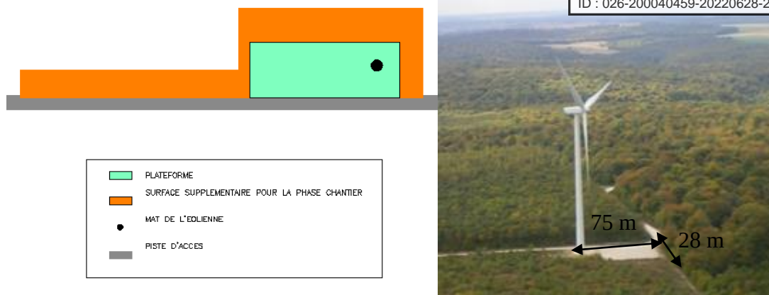
Figure 17 : schéma de principe d'un emplacement d'éolienne (Source RES SAS devenue Q Energy France) à gauche et visuel d'une plateforme en forêt avec des côtes standards (hors plateformes accueillant un poste de livraison ou avec un remodelage après chantier)
