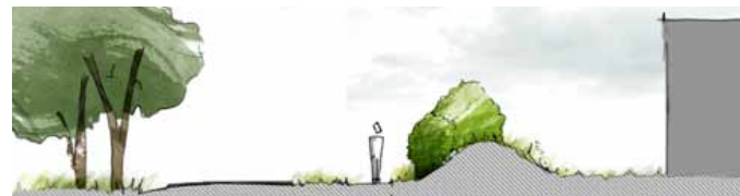
Coupe de principe d'une limite traitée avec un talus planté
