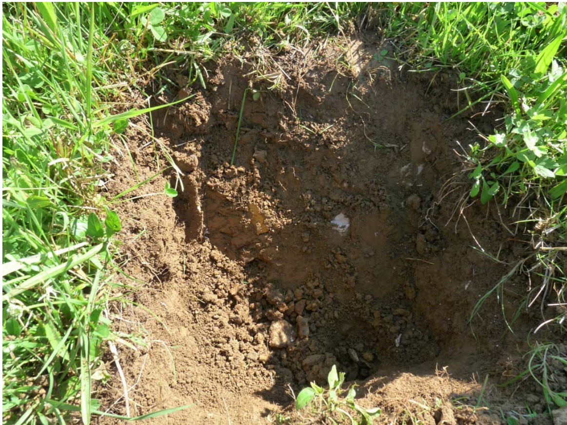
Aspect de la mini fosse réalisée à la pioche sur le point 793. On notera l'absence de phénomènes d'hydromorphie au sein d'une matrice homogène de couleur brun.
