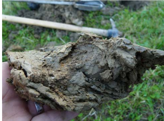
Aspect de la terre fine vers 50 cm de profondeur. La teinte grise de la terre fine est la couleur naturelle de la marne alors que les zones rouille sont dues à l'altération de petits éléments grossiers.
