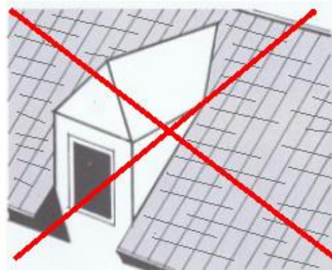
Lucarne en façade interrompant l'avant-toit
