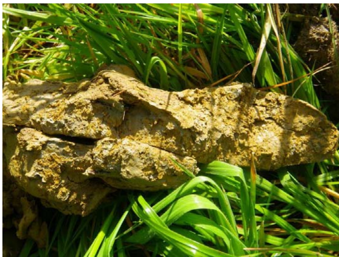
Photo 2 : Relevé à la tarière en zone humide avec présence de traits rédoxiques
