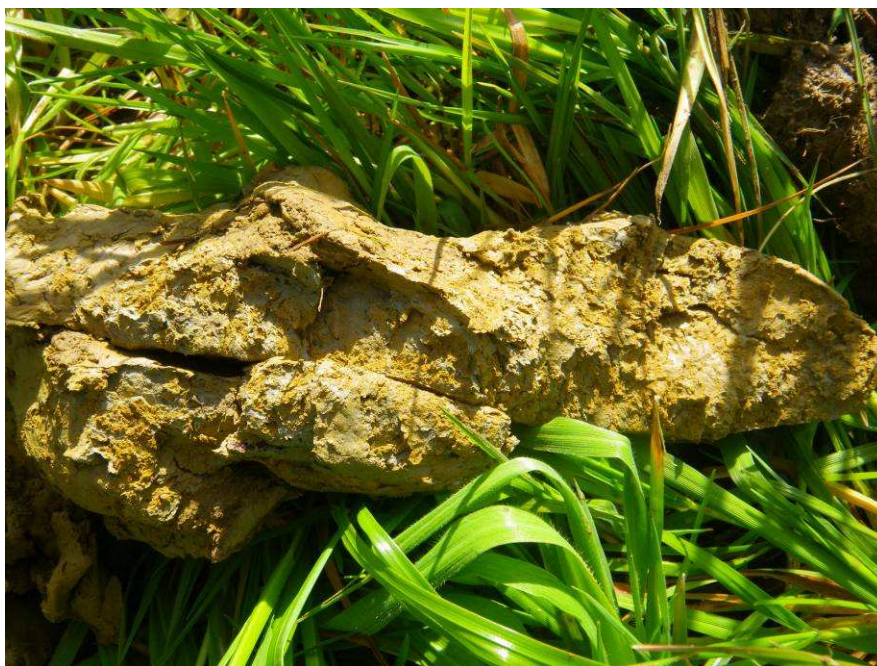
Photo 4 : Relevé à la tarière en zone humide avec présence de traits rédoxiques
