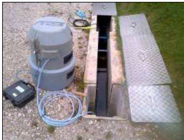
Exemple de mesure débit sur canal venturi
