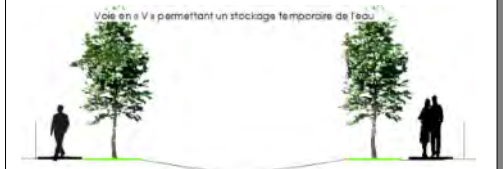
Voie en « V » permettant un stockage provisoire du ruissellement
