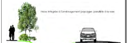
Noue accompagnant la voirie
