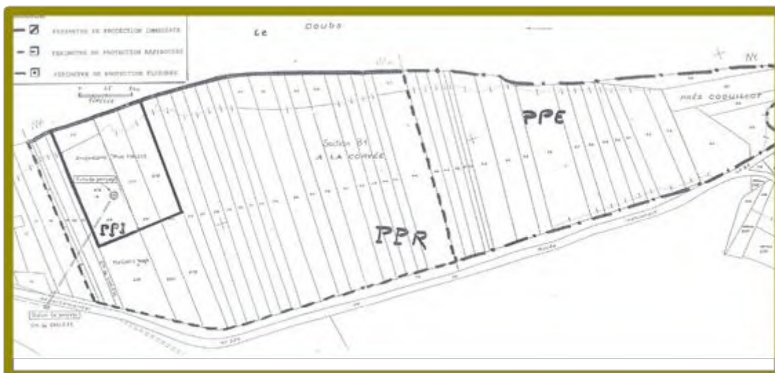
Chalèze – Périètres de protection du captage d'eau potable de la Corvée
