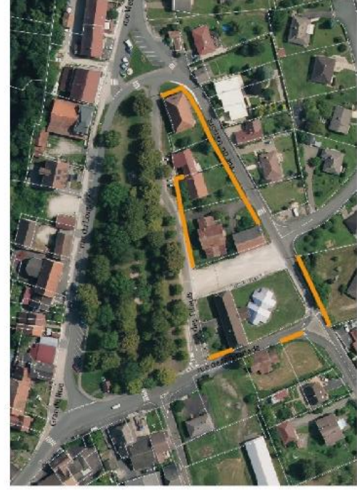
Repérage des linéaires de muret en pierres sèches
