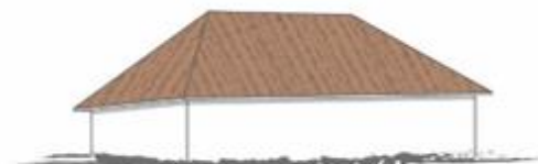
Toiture à croupe
