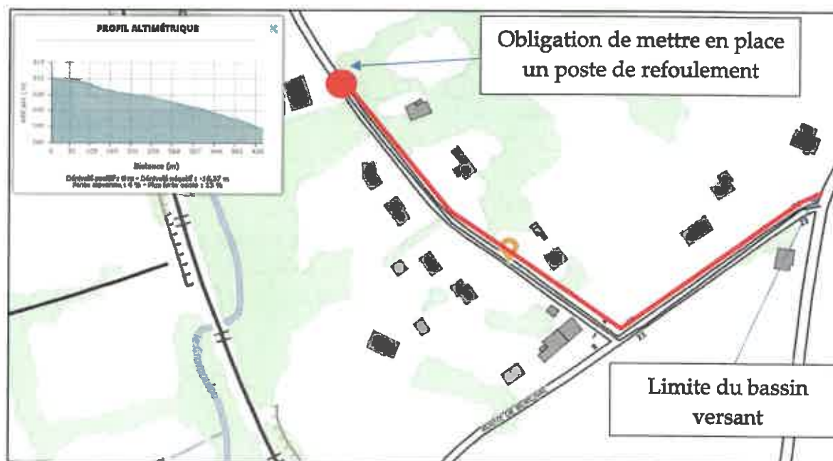
Figure 34 : Profil altimétrique de la route du secteur sud des Farges
