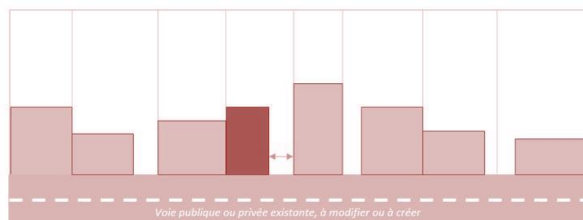
Possibilité 2 : Implantation de la nouvelle construction sur au moins une limite séparative
