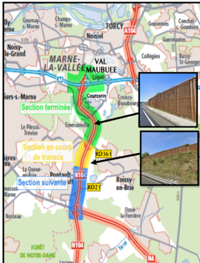
Figure 27: État d'avancement des travaux des mesures anti-bruit sur le RN104
