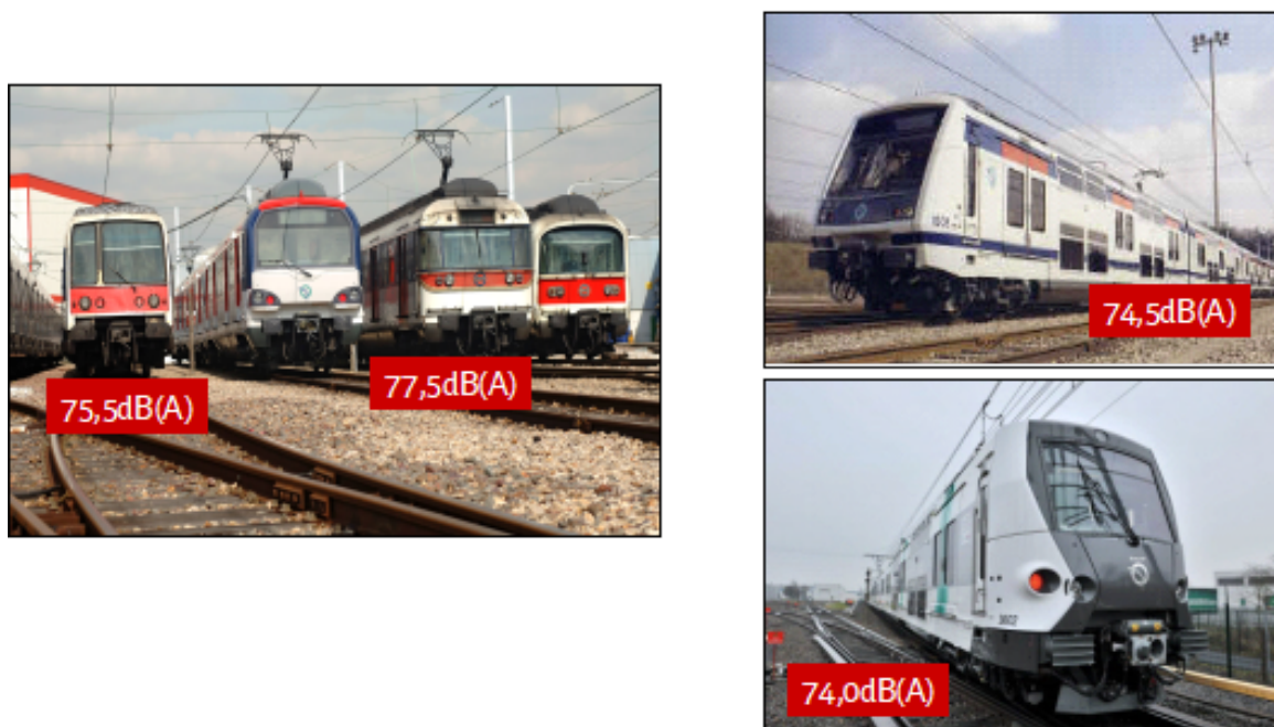
Figure 47: Niveaux sonores, en dB(A), des divers matériels roulants circulant ou ayant circulé sur le RER A, à 80km/h et à 7,5m de l'axe de la voie (NF EN ISO 3095)
