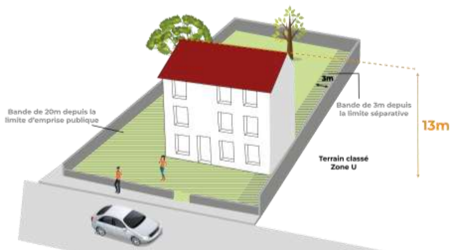
Schémas des hauteurs maximales des constructions en zone Ua par rapport à une bande de 20m mesurée depuis la limite de l'emprise publique – schémas illustratifs, sans valeur réglementaire
