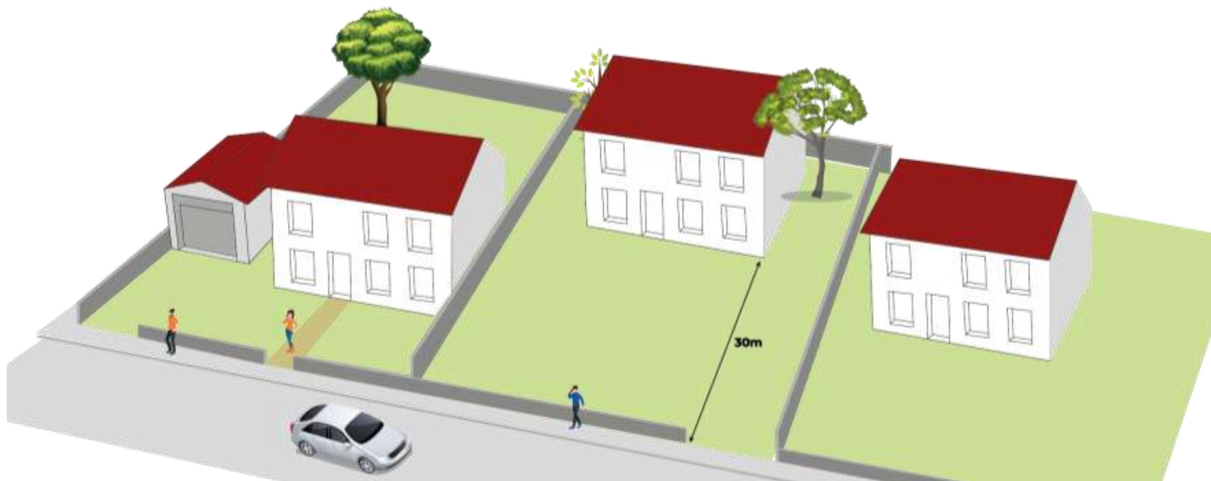
Schémas d'implantations autorisées pour les constructions en zones Ua, Ub et Up par rapport aux limites d'emprises publiques – Possibilité de s'implanter en retrait de 30m par rapport à la limite de la voie ou de l'emprise publique – schéma illustratif, sans valeur réglementaire
