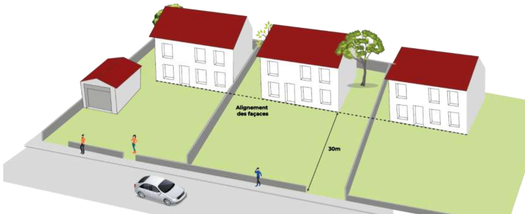
Schémas d'implantations autorisées pour les constructions en zones Ua, Ub et Up par rapport aux limites d'emprises publiques – Possibilité de s'implanter en alignement de façade – schéma illustratif, sans valeur réglementaire
