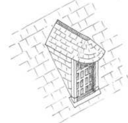
Lucarne pignon maçonné en pierre moulurée
