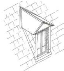
Lucarne pignon et fronton bâti en pierre
