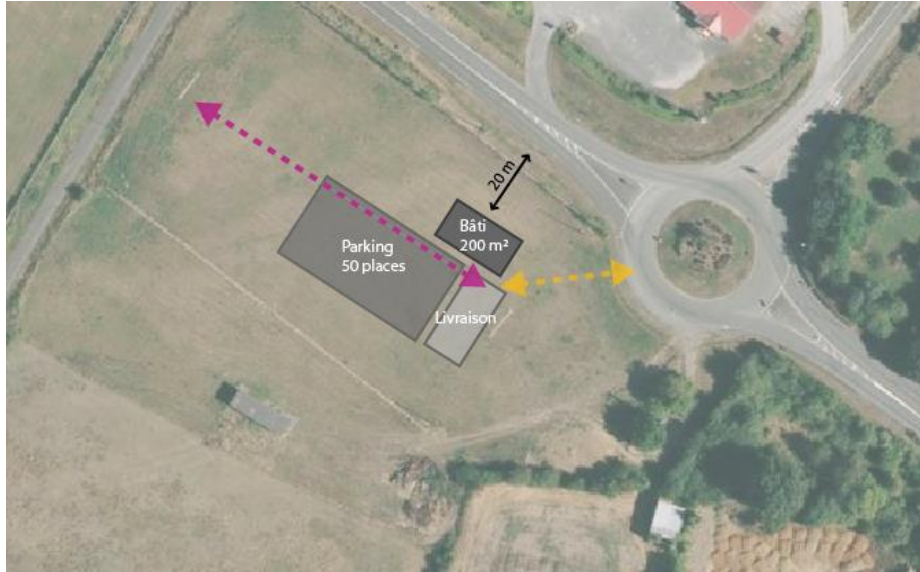
Implantation potentiel du bâti et volumes projetés pour le projet de commerce local, autres surfaces disponibles pour d'autres projets
