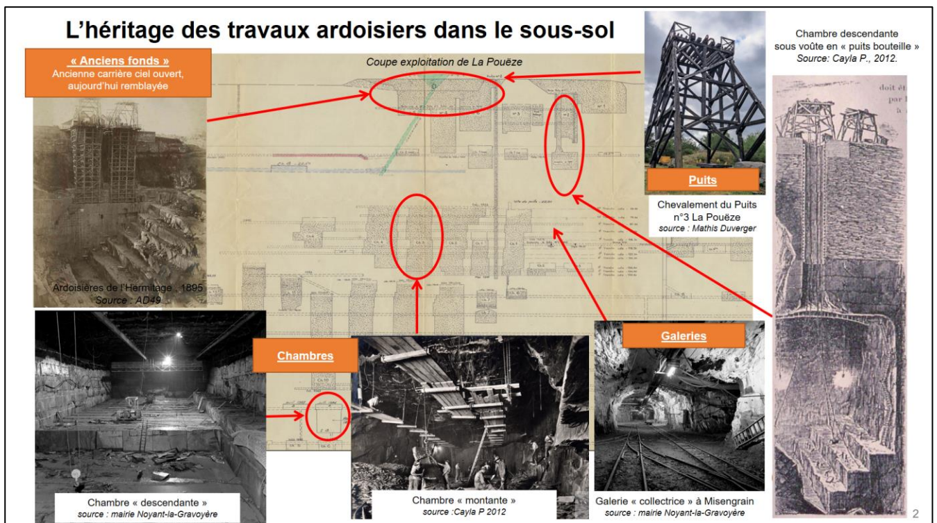
Figure 22 : Illustration de l'héritage des travaux ardoisiers dans le sous-sol
