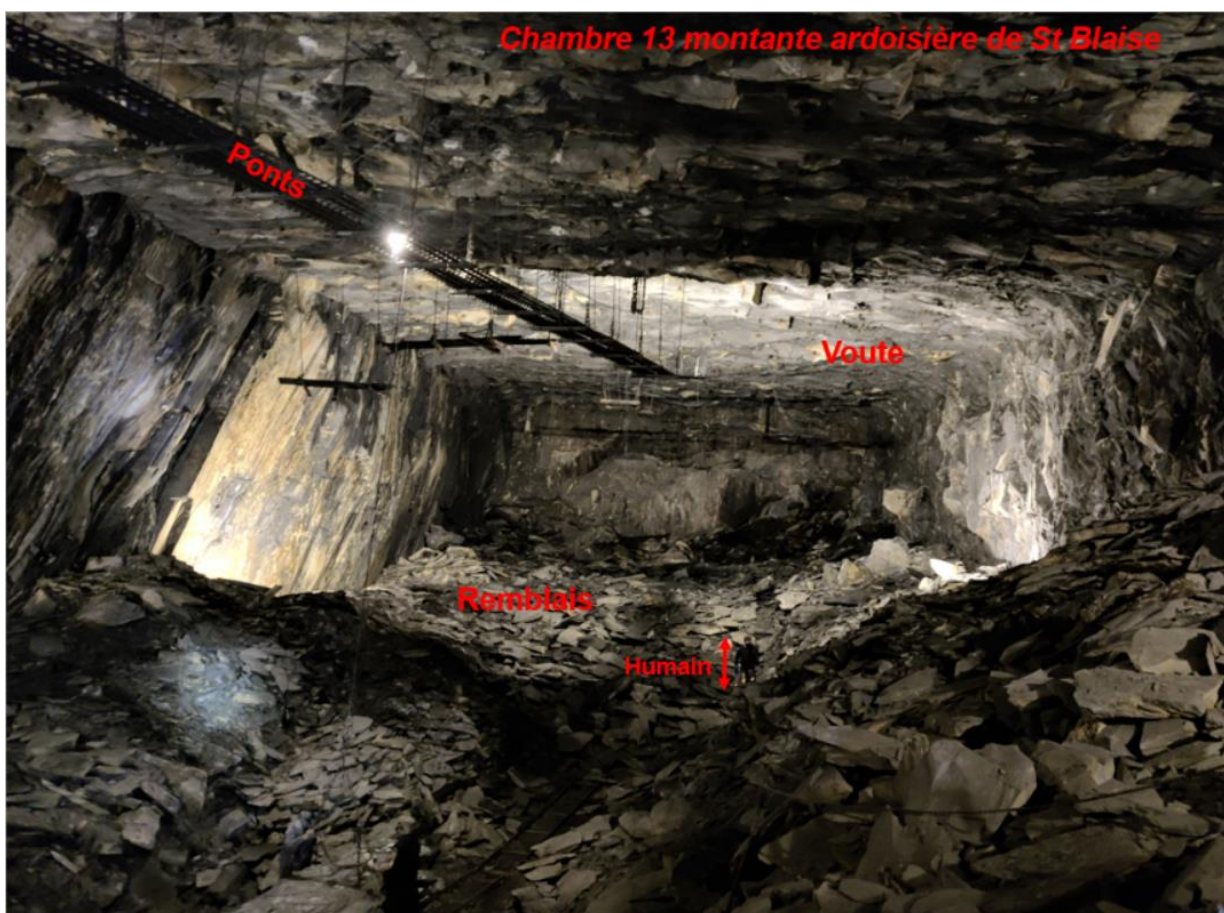
Figure 19 : Photographie depuis la chambre N°13 de l'ancienne ardoisière de Saint Blaise illustrant la méthode d'exploitation en montant (source Mathis Duverger)
