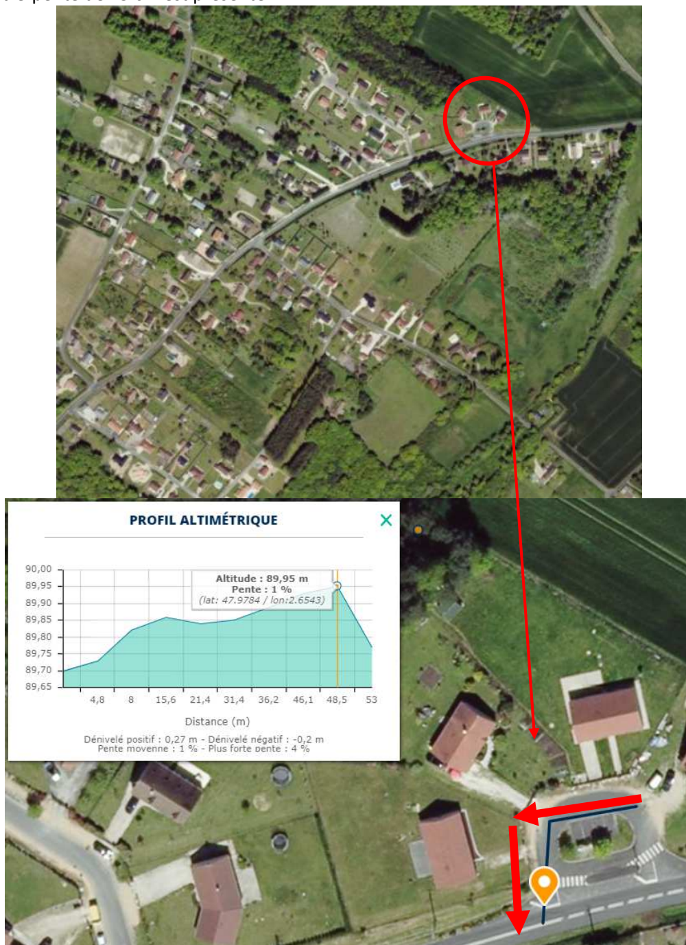
Figure 3-23: difficulté extension de réseau – route de Montargis
