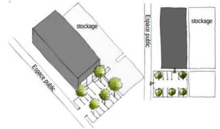
► Positionnés à l'arrière du bâtiment les espaces techniques (stockage,...) sont masqués depuis l'espace public.
