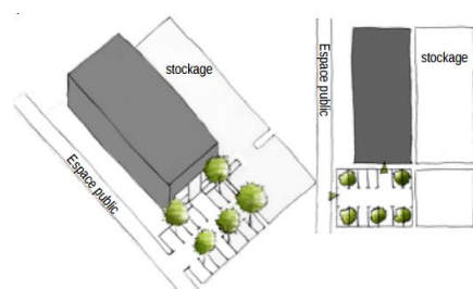
► Positionnés à l'arrière du bâtiment les espaces techniques (stockage,...) sont masqués depuis l'espace public.
