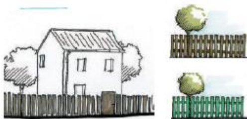
clôture à claire-voie, en métal ou en bois
