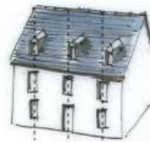
Lucarnes positionnées sur les axes des travées
