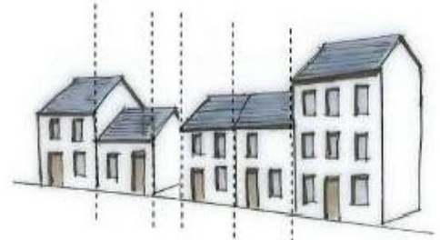
Principe de composition de façade qui respecte le rythme des travées
