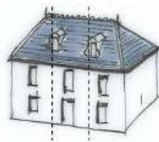
Lucarnes positionnées sur les axes des trumeaux
