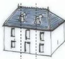
Lucarnes positionnées sur les axes des trumeaux
