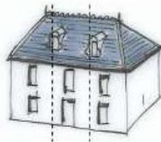
Lucarnes positionnées sur les axes des trumeaux
