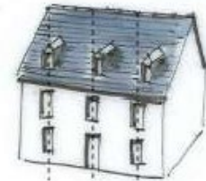
Lucarnes positionnées sur les axes des travées
