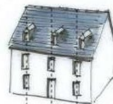
Lucarnes positionnées sur les axes des travées
