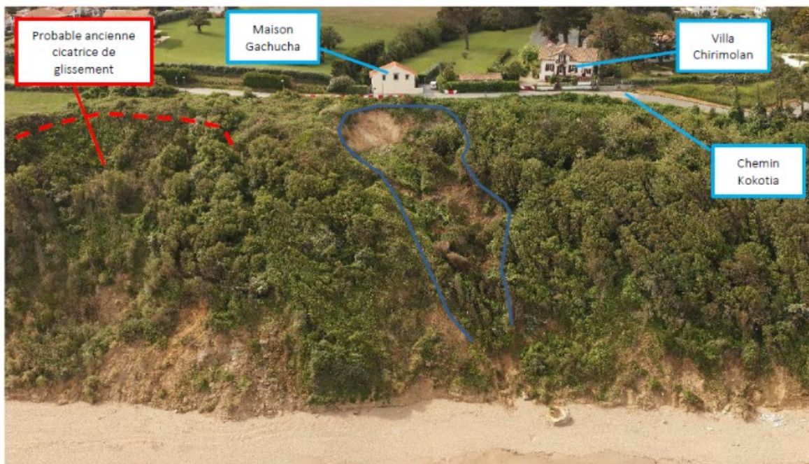
Illustration 45 - Vue aérienne de la couronne du glissement de Lafitena en décembre 2021 (Garnier, 2022)
