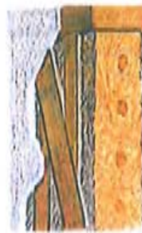
mur en pans de bois et ferails enduit à la chaux
