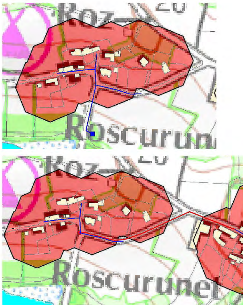
Figure 71 : scénario assainissement collectif du Roz avec en haut la construction d'une station d'épuration et en bas la construction d'un poste de relèvement raccordé au secteur de Roscurunet (scénario valable si le scénario assainissement collectif est retenu sur ce secteur).
