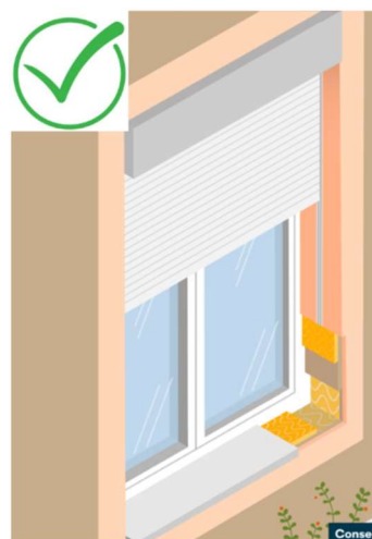
Menuiserie au milieu du mur porteur avec retour isolé
