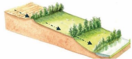
Placé perpendiculairement à la pente, le réseau de haies contribue à limiter l'érosion des sols.
