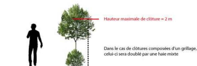
Clôture principalement composée d'un grillage
