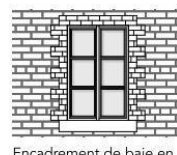
Encadrement de baie en briques
