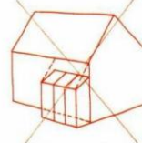
Pente de toit trop faible, ne respectant pas celle de la maison
