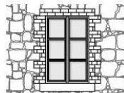
Encadrement de baie en briques
