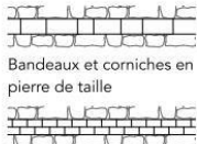
Bandeaux et corniches en pierre de taille
