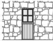
Porte simple en bois à lames verticales et partie supérieure vitrée
