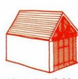
Pignon charpenté vitré
