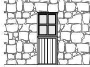
Porte simple en bois à lames verticales et partie supérieure vitrée
