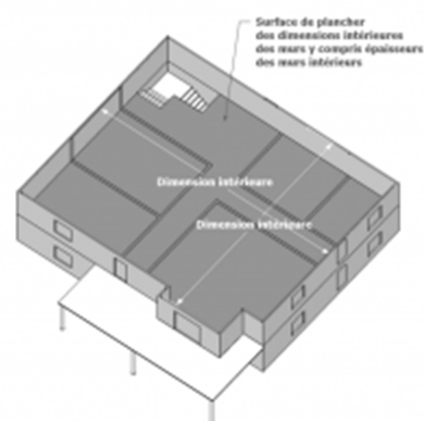
Surface de plancher finale de l'étage
