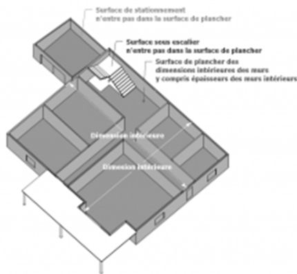
Surface de plancher du rez-de-chaussée
