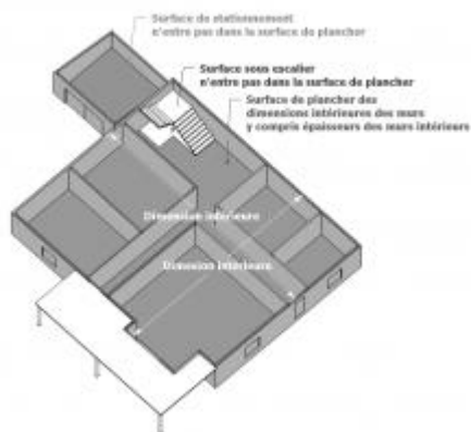
Surface de plancher du rez-de-chaussée
