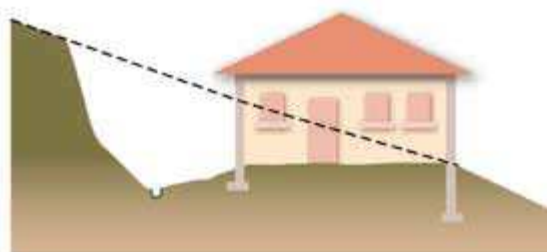
Plate-forme en déblais
