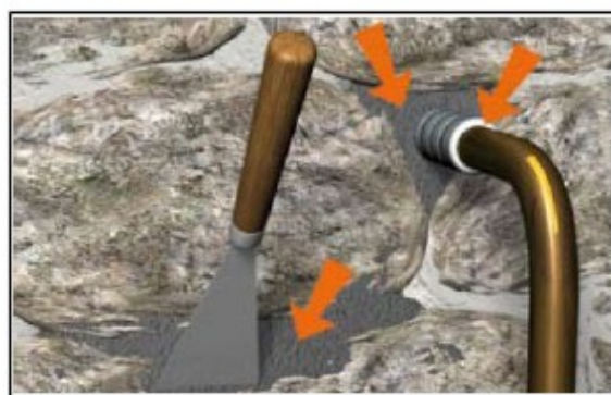
Situation après travaux de colmatage
