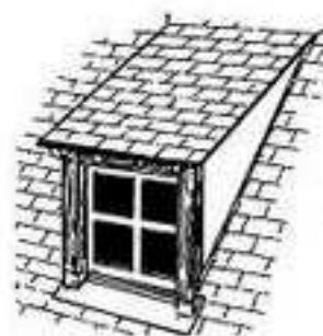
lucarne rampante ou en chien couché
