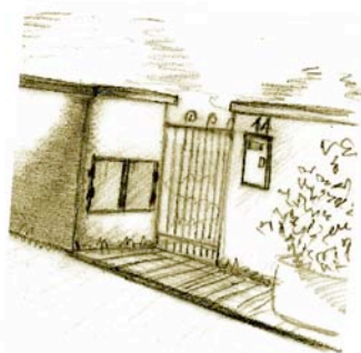
Intégration des équipements techniques dans un mur
