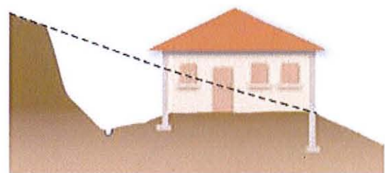
Plate-forme en déblais
