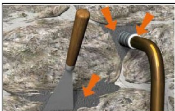
Situation après travaux de colmatage
