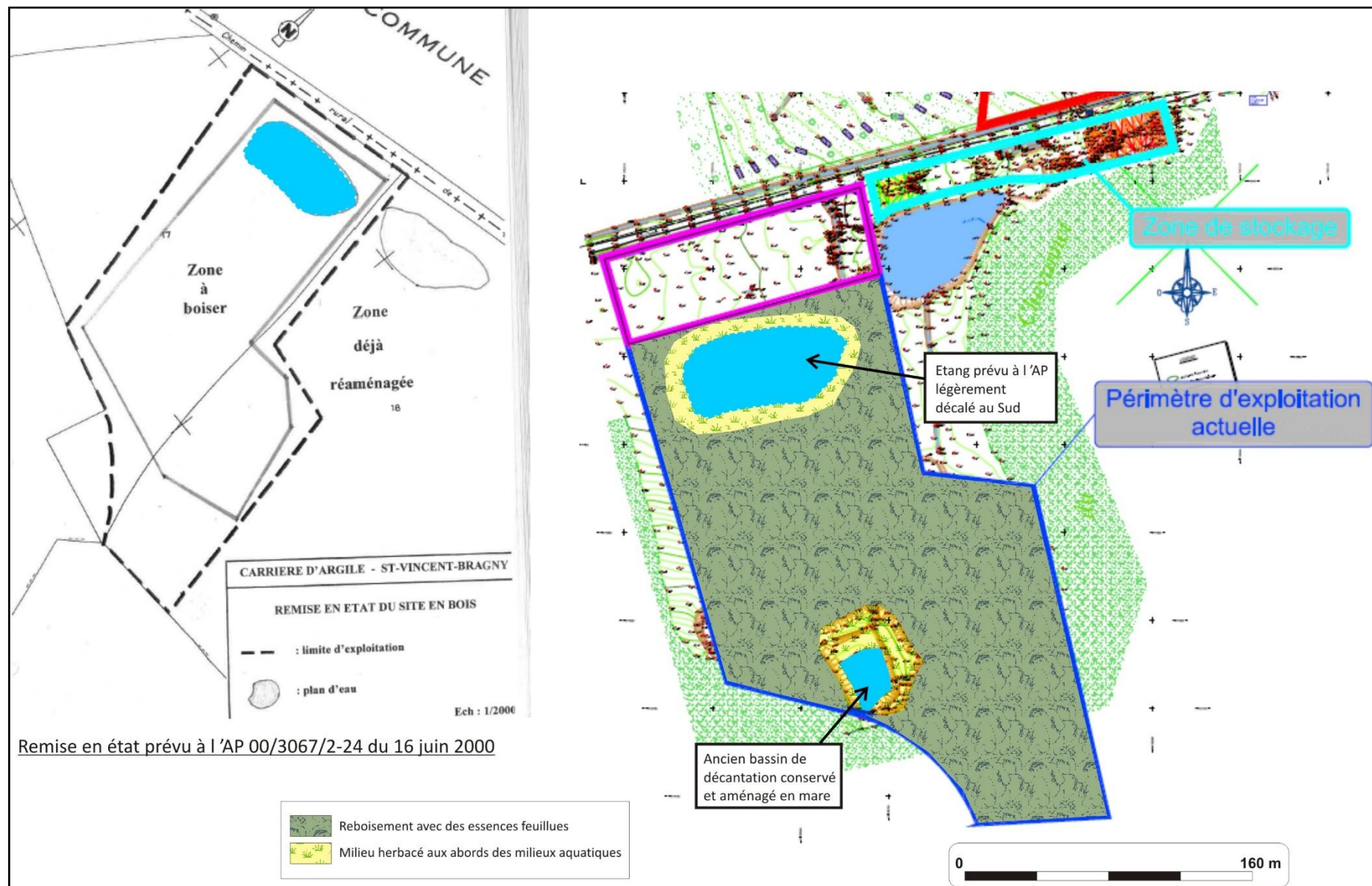
Figure 8 : Comparaison de la remise en état prévue à l'AP du 16/06/2000 avec l'état final
