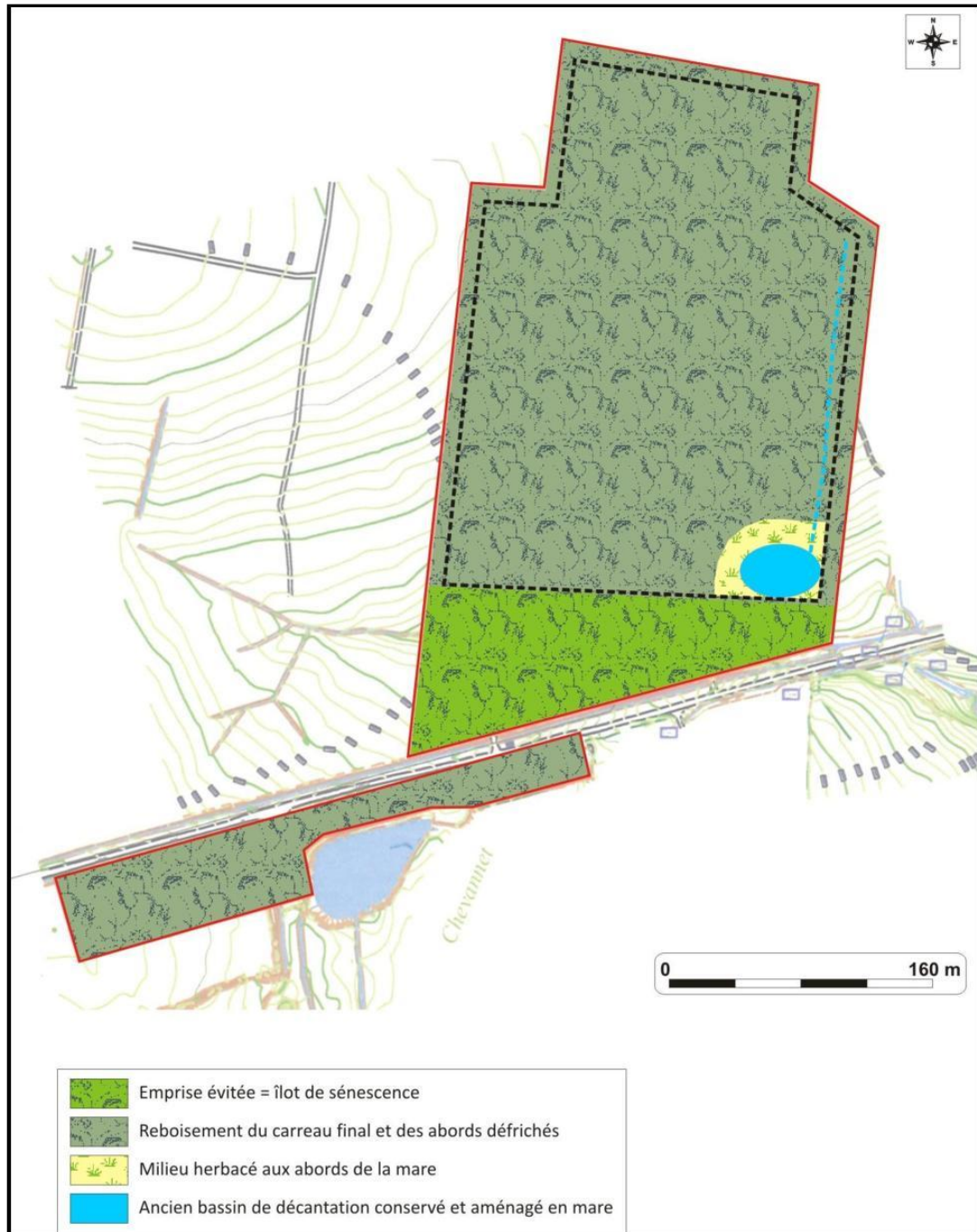
Figure 2 : Principe de remise en état de la carrière
