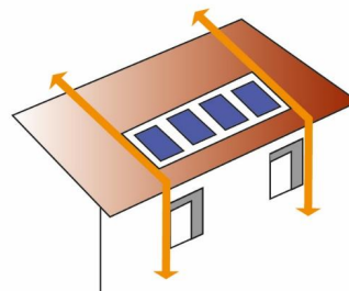
Implantation horizontale Alignement du champ de capteurs avec les ouvertures de façades
