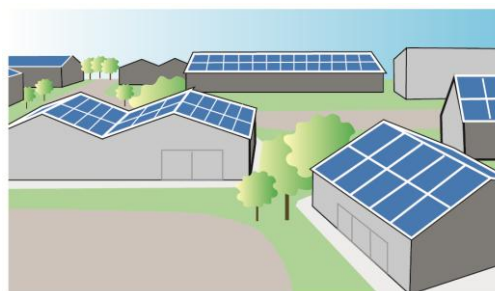
Implantation couvrant la totalité d'un ou de plusieurs pans de toiture dans le cadre d'un bâtiment technique ou industriel
