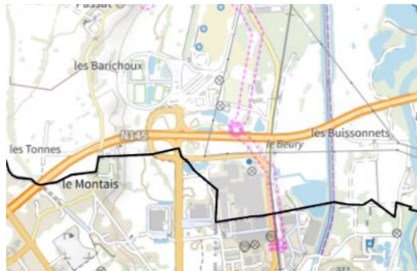
Réseau de canalisation de Gaz naturel : Servitude I1 représentée par la double ligne rose – source: Géoportail de l'urbanisme
