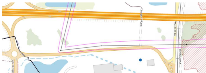
Passage de lignes à haute tension : Servitude I4 représentée par la double ligne rose, source: QGIS
