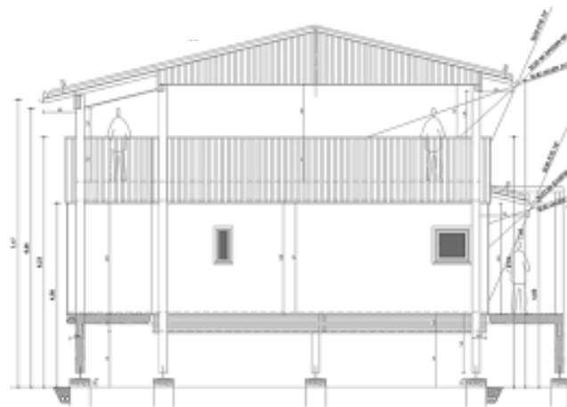
Construction sur pilotis - Source : CAUE Occitanie
