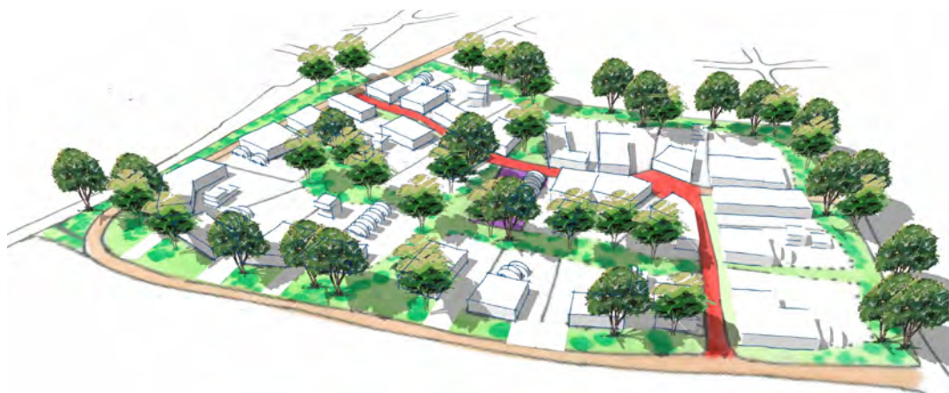
Simulation de zone d'activités : regroupement du stationnement, large place prévue pour les espaces verts, toitures des bâtiments homogènes (toits terrasses), voirie traversante, espaces piétonniers...
