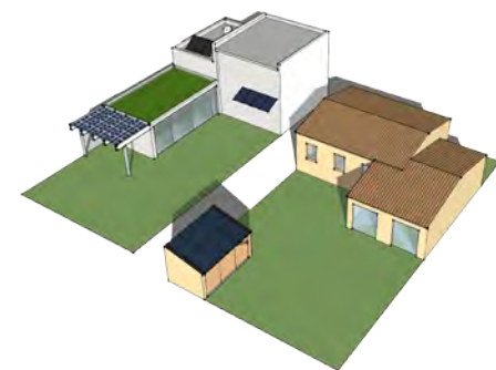
Panneaux implantés sur annexes, en brise-soleil
