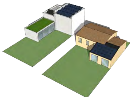
Panneaux implantés sur un pan entier de toiture
