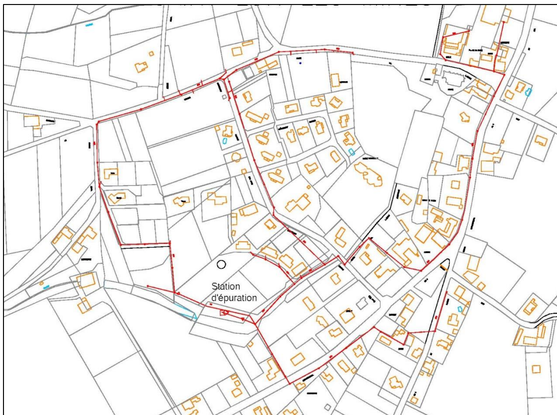
Figure 12 : Réseau d'assainissement de la commune de Saint-Lon-les-Mines
