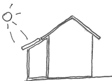
Toiture 2 pans égaux (+ véranda)
