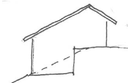
Toiture 2 pans inégaux justifiés par l'adaptation à la pente
